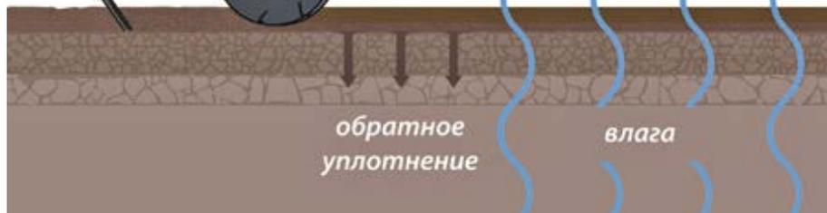
**Пассивный режим** применяется в случаях, когда необходимо спровоцировать активное прорастание сорняков при обработке паров или предпосевной подготовке почвы. За счет обратного уплотнения почвы, возникающего благодаря эффекту «прижима», ускоряется формирование капиллярных связей между глубоким и поверхностным слоями почвы.
