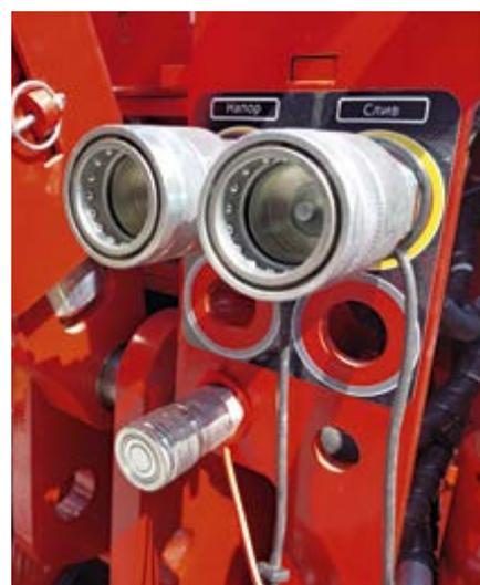
**Гидравлическая система** с изменяемой производительностью в зависимости от нагрузки обеспечивает регулировку и подачу давления по необходимости. При отсутствии необходимости в высоком давлении система переходит в режим низкого давления, создавая резерв энергии и экономя топливо. Отдельный контур рулевого управления обеспечивает стабильную подачу давления, не снижая производительности гидравлики рабочего оборудования.
