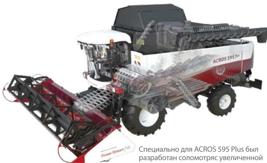
Специально для ACROS 595 Plus был разработан соломотряс увеличенной площади, обеспечивающий более интенсивный процесс сепарации.
