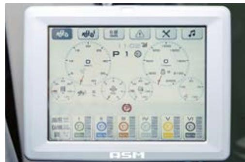
**Цветной сенсорный монитор 8,4"** объединяет в себе приборную панель и гибкий инструмент для настройки параметров и мониторинга работы. В монитор встроены функции MP3-проигрывателя и радио.
