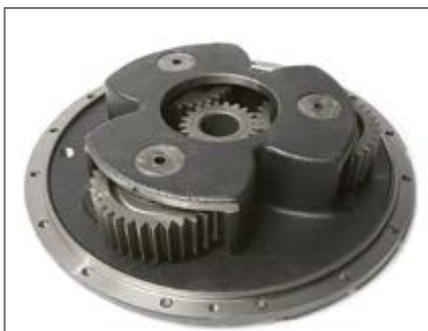
**Эти редукторы с планетарными передачами** передают всю возможную мощность через большую высокоточную солнечную шестерню. Ступицы планетарного механизма подвешены на подшипниках большого диаметра, прикрепленных прямо к балке моста. Вся нагрузка приходится на балку моста, а не на приводные компоненты.
