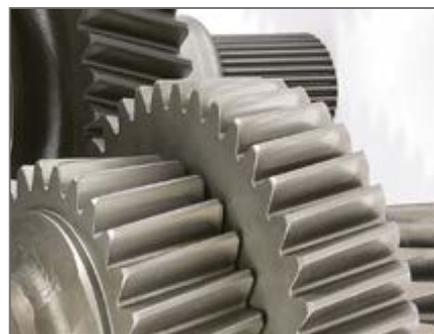
**Косозубые передачи** создают больший контакт между зубцами, что обеспечивает более надежную передачу мощности, плавное переключение и сокращает шум трансмиссии.
