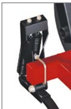
**Конструкция крепления стойки к раме** предусматривает использование только одного прочного болта, позволяя экономить время и средства при его замене.
