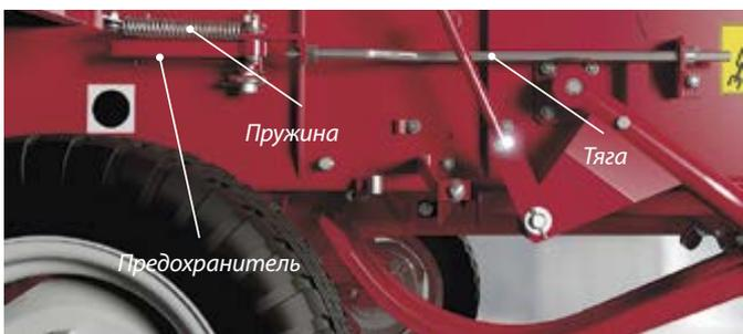
Для предохранения выхода узлов пресс-подборщика из строя по причине забивания массой или попадания посторонних предметов в рабочие органы предусмотрен срезной болт, через который передается крутящий момент с маховика на главный редуктор машины.
