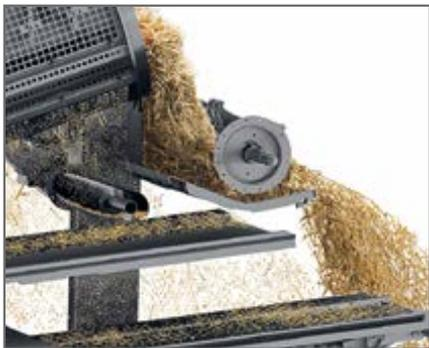
**До последнего зерна.** Соломистая масса, прежде чем попасть в измельчитель, проходит финишную сепарацию через битер с решетчатой декой, установленный на выходе из ротора.
