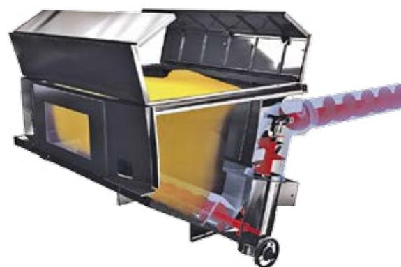
Скорость выгрузки составляет 90 л/с, полный бункер опустошается не более 2 минут. Трансформируемая крыша, датчики уровня заполнения, гидропультаторы для выгрузки влажного зерна и другие конструктивные особенности создают дополнительные удобства и повышают эффективность работы.
