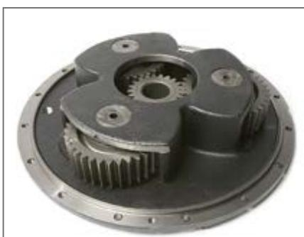
**Эти редукторы с планетарными передатками** передают всю возможную мощность через большую высокоточную солнечную шестерню. Ступицы планетарного механизма подвешены на подшипниках большого диаметра, прикрепленных прямо к балке моста. Вся нагрузка приходится на балку моста, а не на приводные компоненты.
